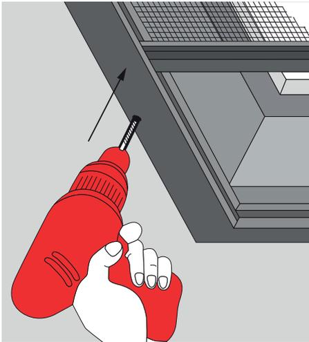
4. Richten Sie den vorgebohrten Einbaurahmen am Blendrahmen aus.
