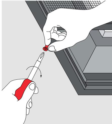
5. Falls erneut erforderlich, Einbaurahmen am Blendrahmen ausrichten.
