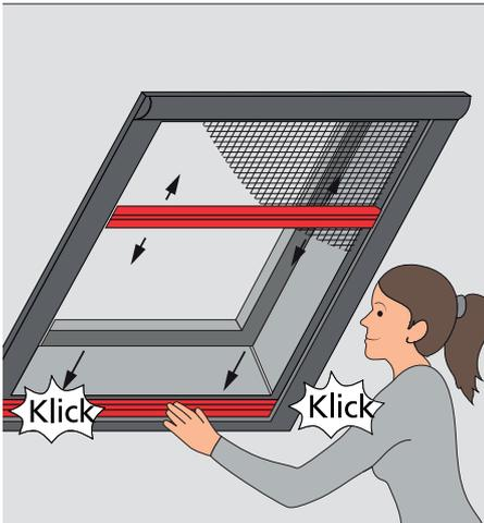
7. Fassen Sie mit der Hand an die Zugschiene und ziehen Sie diese vorsichtig nach unten. Die Zugschiene rastet durch sanftes Hineindrücken in der Endposition ein. Drücken Sie erneut mit der Hand die Zugschiene nach unten.
