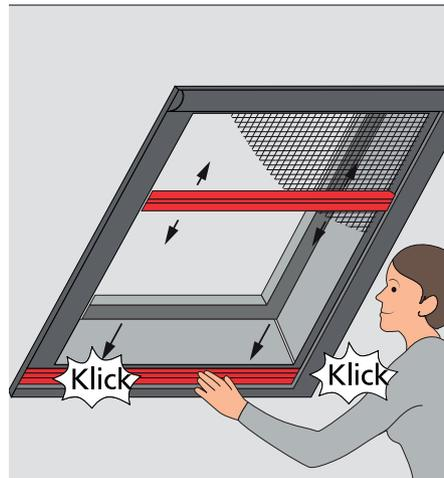
11. Fassen Sie mit der Hand an die Zugschiene und ziehen Sie diese vorsichtig nach unten. Die Zugschiene rastet durch sanftes Hineindrücken in der Endposition ein.
