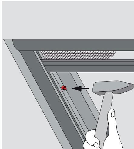
5. Klopfen Sie gefühlvoll mit einem Hammer auf die Federstifte und markieren sie so das Bohrloch.
