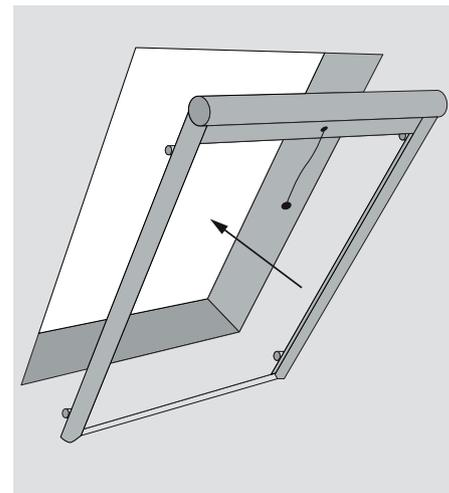
3. Rollo in die Fensterlaibung einsetzen und ausrichten.
