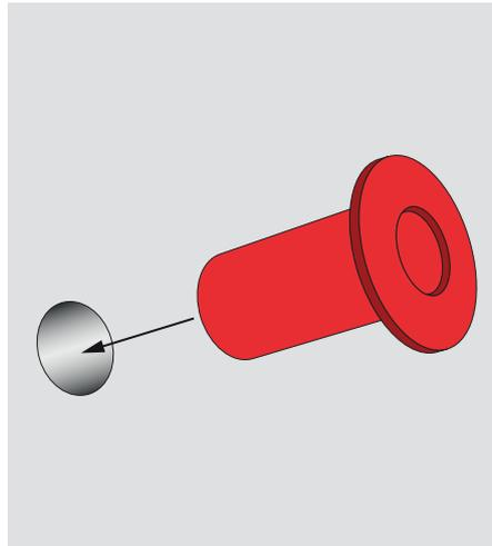
8. Hülsen in die Bohrungen einsetzen und mit Hammer vorsichtig einklopfen.
