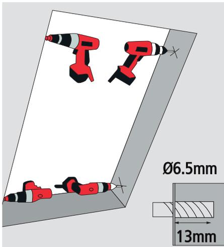
7. Löcher (Bohrer 6,5mm) an den markierten Stellen in der Laibung bohren.
