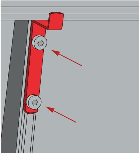
1. Einhängewinkel an die bereits eingeschobenen Schlitten mittels beiliegenden Schrauben befestigen.
