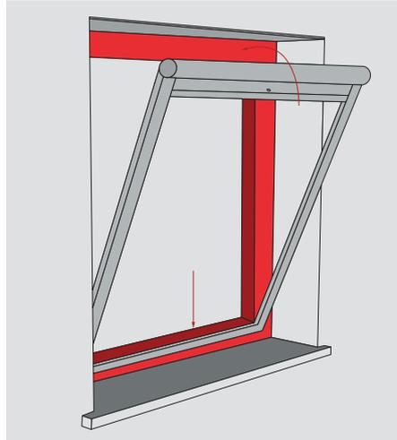
2. Rolloelement über Fensterfalz heben. Nach unten drücken, bis die Einhängewinkel komplett auf der Oberkante des Falzes aufliegen
