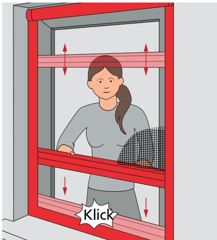
4. Fassen Sie mit der Hand an die Zugschiene und ziehen Sie diese vorsichtig nach unten. Die Zugschiene rastet durch sanftes Hineindrücken in der Endposition ein.
