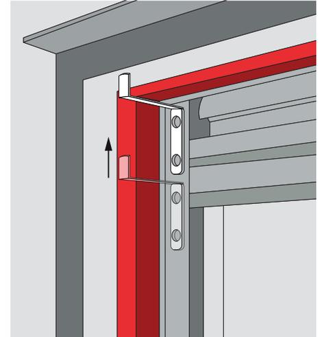
3. Rolloelement an das Fenster heran ziehen und halten. Schrauben der oberen Einhängewinkel lösen, Einhängewinkel bis zum Anschlag nach oben schieben und wieder befestigen
