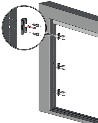
2. Befestigungsclip [ 3 Stk. pro Seite ] bauseitig befestigen. Jeden Befestigungsclip 1x mittig verschrauben.
