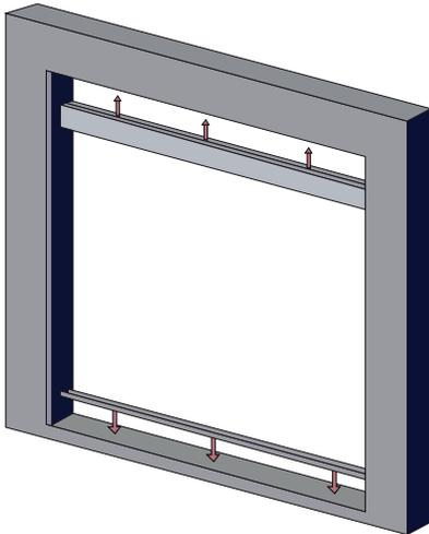
1. Obere Führungsschiene fixieren und entsprechend bauseitigem Untergrund mit geeigneten Schrauben befestigen.
