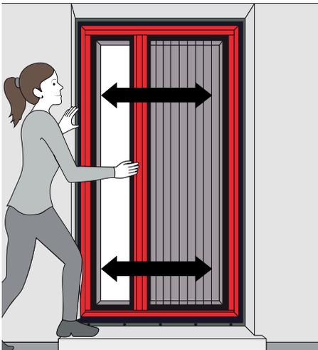
4. Prüfen Sie das Plissee auf Funktion in dem Sie es einmal komplett öffnen und schließen. Im Fall, dass das Plissee schwergängig läuft oder die Schnüre durchhängen, Schnüre wie im nächsten Schritt beschrieben einstellen. Ansonsten ist die Montage beendet.
