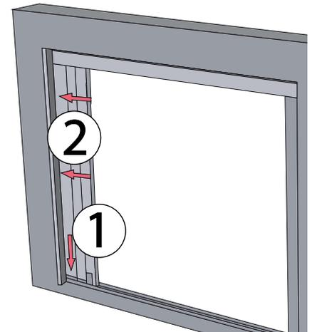
3. ① Plisseepaket in untere Führungsschiene einrasten lassen
