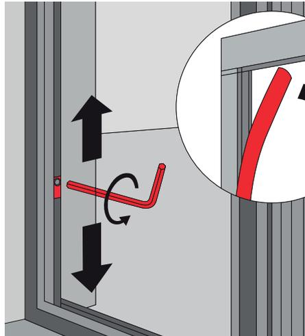
5. Entfernen Sie das eingepresste Magnetband aus dem vertikalen Profilschenkel der Verschlussseite [Abb. Kreis].
