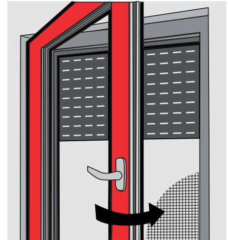
6. Verschluss- und Kippfunktion des Fensters / der Tür prüfen. Rollläden auf Funktion prüfen.
