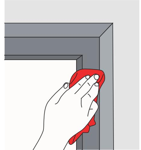
6. Verschlussseite des Blendrahmens reinigen und entfetten.
