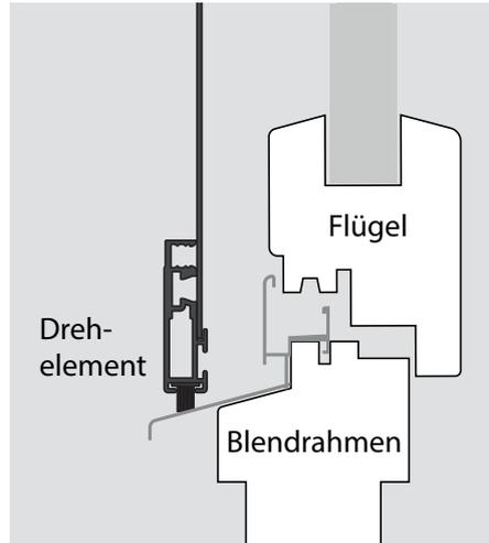
2. ohne Druck auf der Bürste unten, an der Stockabdeckung abschließen lassen und auf 3-seitig gleichmäßigen Überstand achten.
