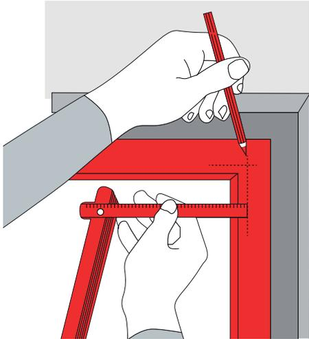
1. Drehrahmen gegen den Blendrahmen drücken, ausrichten und auf gleichmäßige Überlappung achten.
