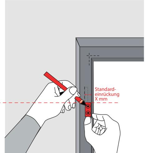
3. Drehrahmen zur Seite stellen und die Scharniere an der Markierung ansetzen. Das Scharnierteil ist unter der Markierung zu platzieren. Löcher anzeichnen.
