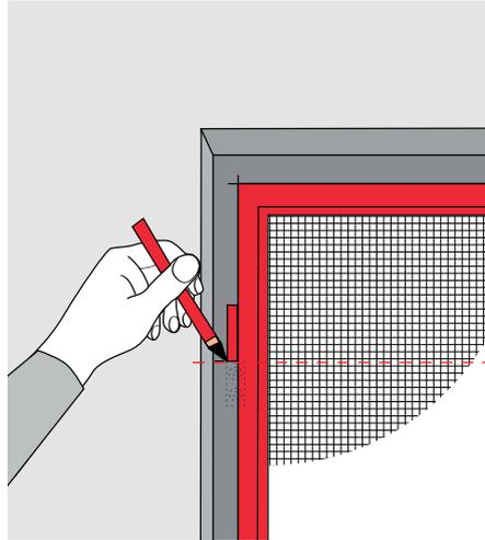
2. Mit einem Stift die Unter- und Außenseite der Scharniere am Blendrahmen markieren
