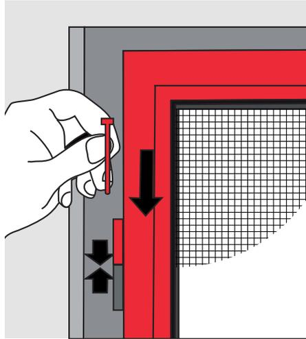
5. Drehrahmen auf Scharniere setzen und Scharnierstifte komplett einschieben
