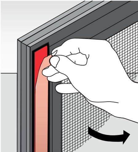
7. Am Magnetband die Schutzfolie abziehen und exakt am Flügel positionieren. Nun den Drehrahmen fest gegen den Blendrahmen drücken und vorsichtig wieder öffnen.
