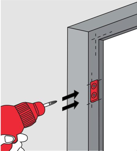
4. Selbstschneidende Schrauben nutzen um Scharniere zu verschrauben.
