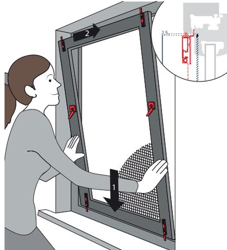
2. Spannrahmen sicher an den Griffen nehmen und in die lichte Öffnung des Blendrahmens drücken, bis die Einhängewinkel an der Innenseite des Rahmenüberschlags (ggf. an der Gummidichtung) anliegen. Von unten beginnen.
