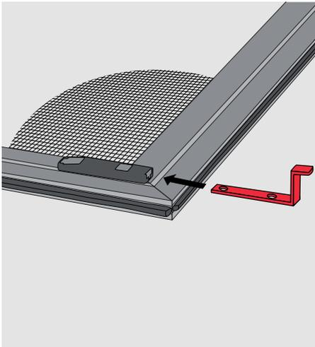
1. Beiliegende Einhängewinkel in die vormontierten Kunststoffaufnahmen stecken und einrasten lassen
